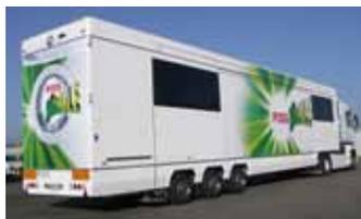
Semi V.I.P. Podium de 65 m<sup>2</sup> avec deux tiroirs latéraux et plancher hydraulique.
